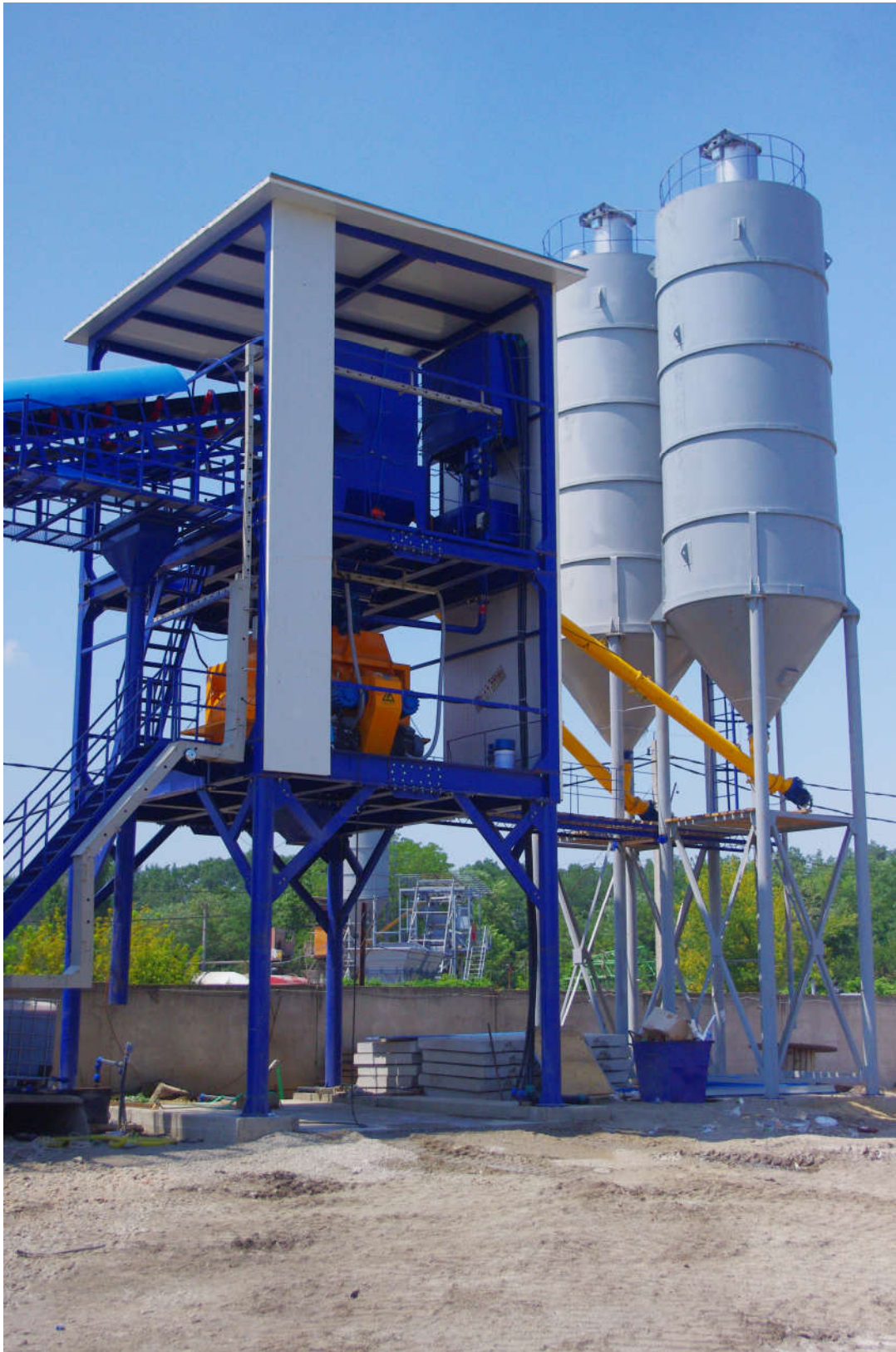
Фото БСУа-120h-л (башня смесителя и силоса цемента)
